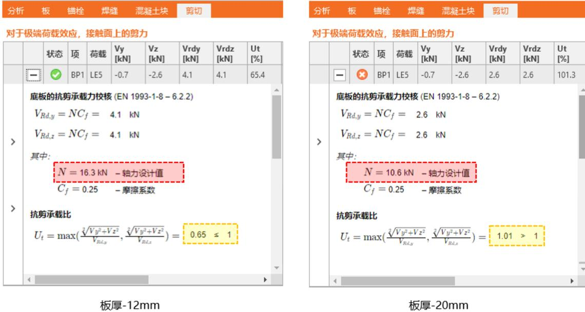
图 2 不同板厚的抗剪验算结果
