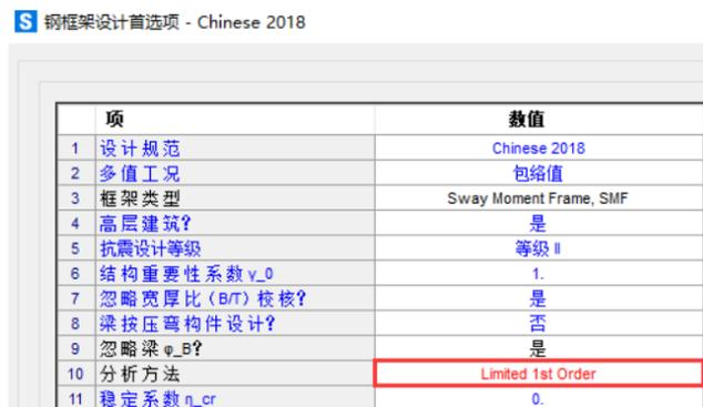
图 2 钢结构防火设计采用一阶方法
