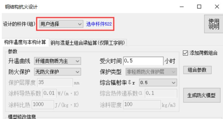
图 3 选择构件并输入计算参数
