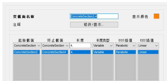
图 12 钢-混结合段变截面定义
