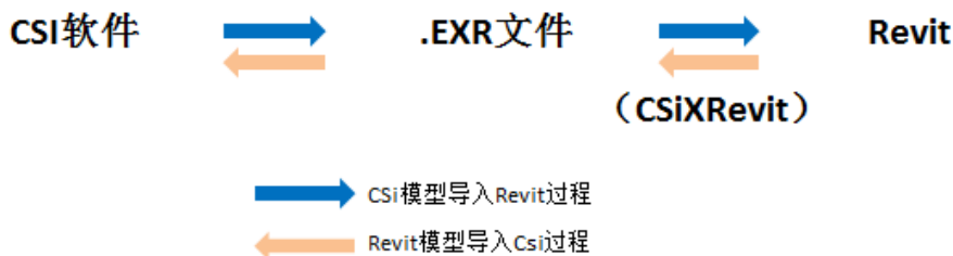
图 2 SAP2000 与 Revit 模型互相转换过程
