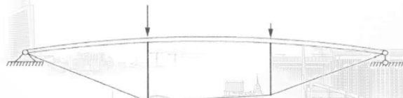
(b) 在固定集中力作用位置布置撑杆
