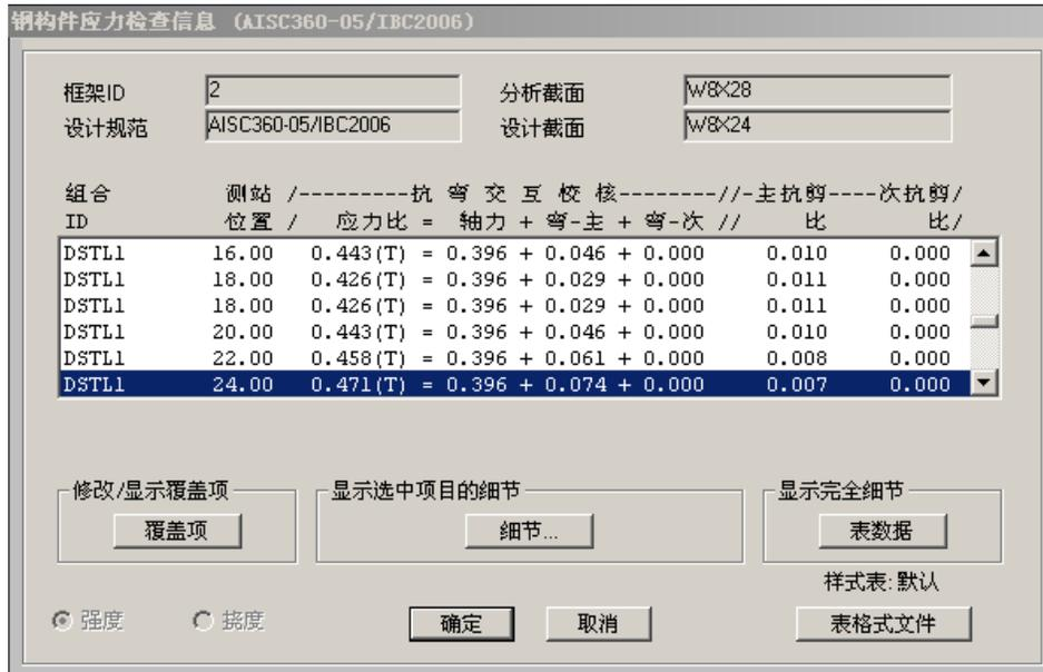
图 53 钢构件应力检查信息对话框
