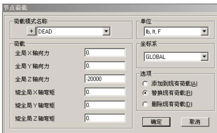
图 35 节点荷载对话框
