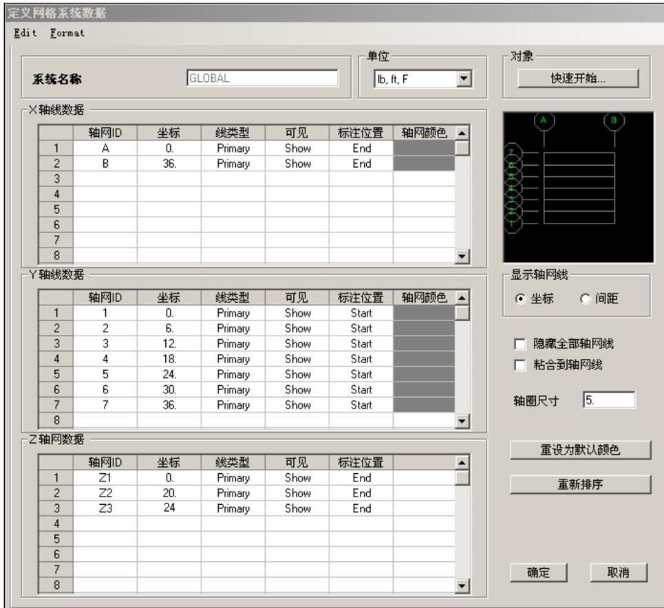
图 6 定义网格系统数据对话框
