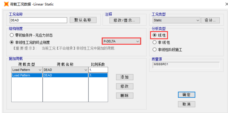
图9-5 使用P-Δ刚度的线性工况
