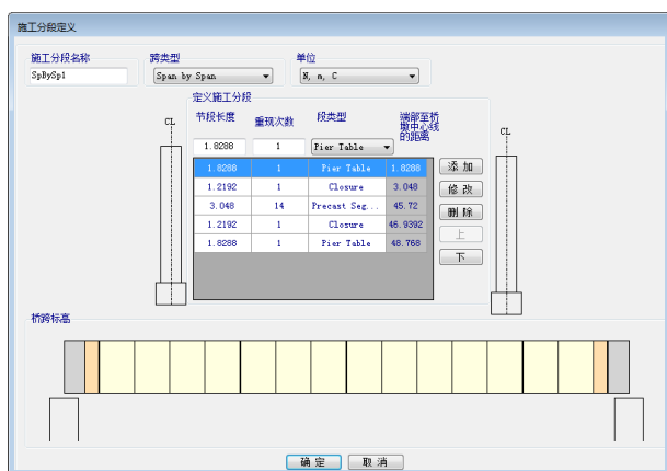
图 5 逐跨施工段“施工分段定义”窗口
