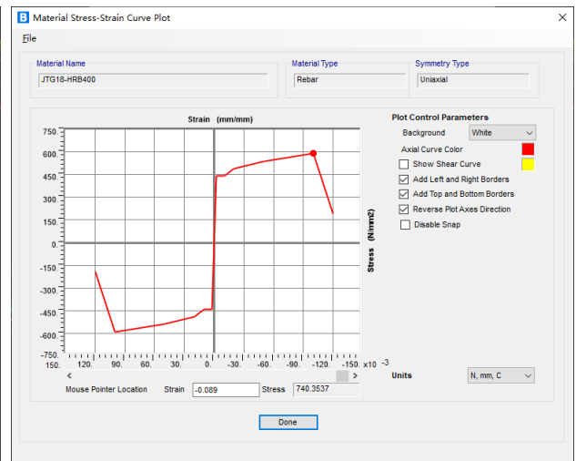
图 3-b 钢筋的应力-应变曲线
