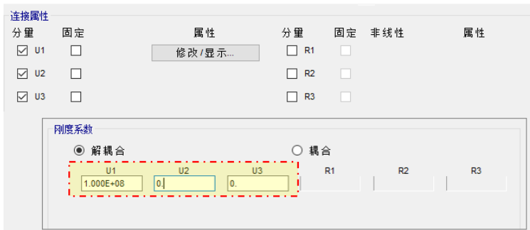
修改后，支座 linear 连接单元的设置
