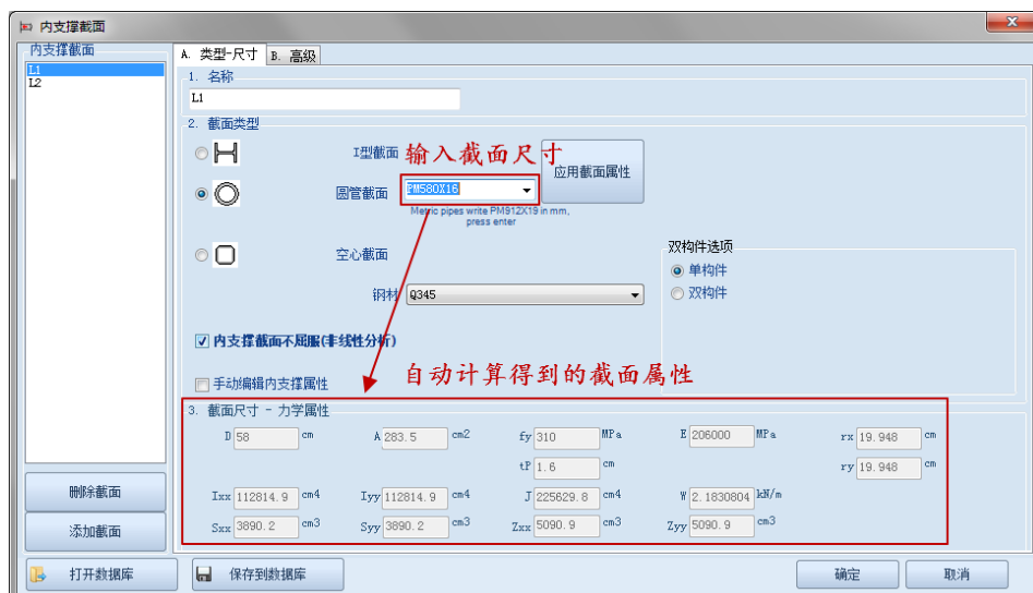
图 7 自行设置圆钢管截面
