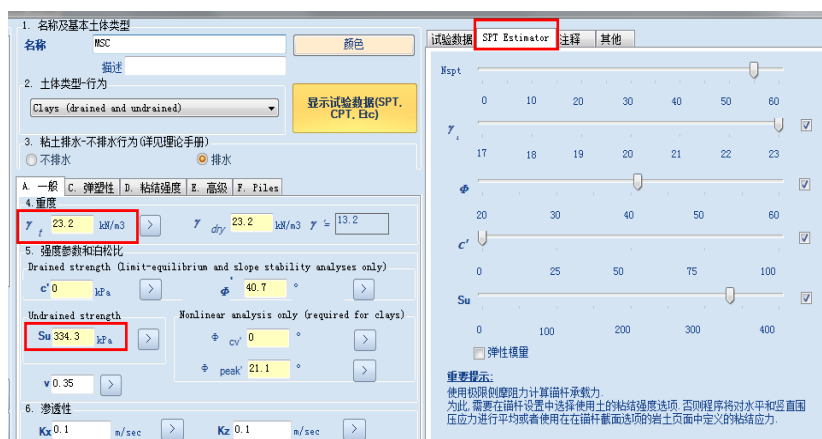
图4 利用SPT锤击数估算黏土重度和抗剪强度
