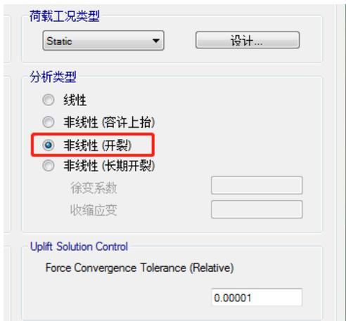
图 2 瞬时开裂挠度工况设置
