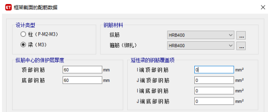
图 7 梁配筋信息（设计配筋时填为 0）
