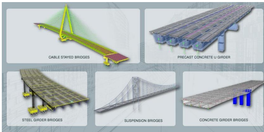
图 1 快速建模支持的桥梁类型
