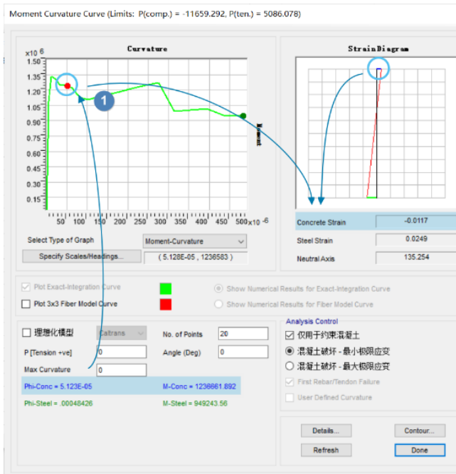
混凝土达到极限压应变
