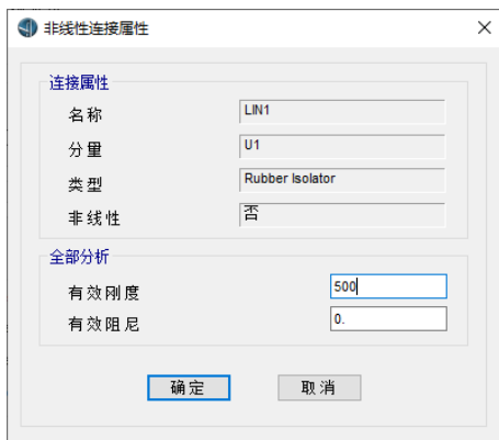
图 4-a U1 方向非线性连接属性
