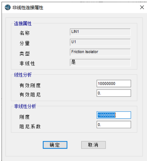
图 9-a U1 方向非线性连接属性
