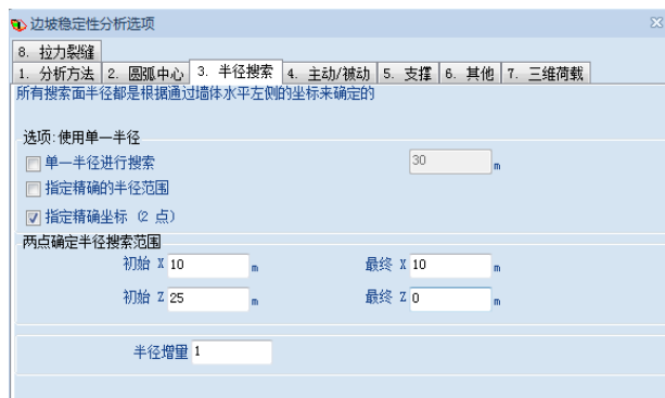
图8 边坡分析选项中半径搜索区域设置
