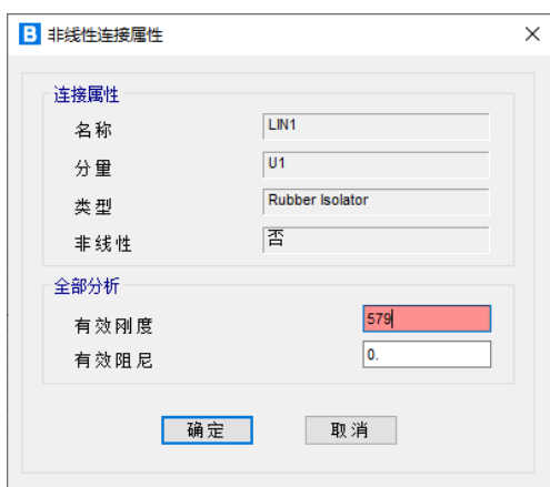
图 6-a U1 方向非线性连接属性
