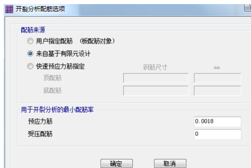
图 4 开裂分析配筋选项
