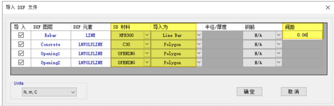
图 12.导入空心桥墩截面的 DXF 文件
